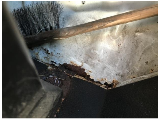
Rozsáhlá koroze částech karoserie
