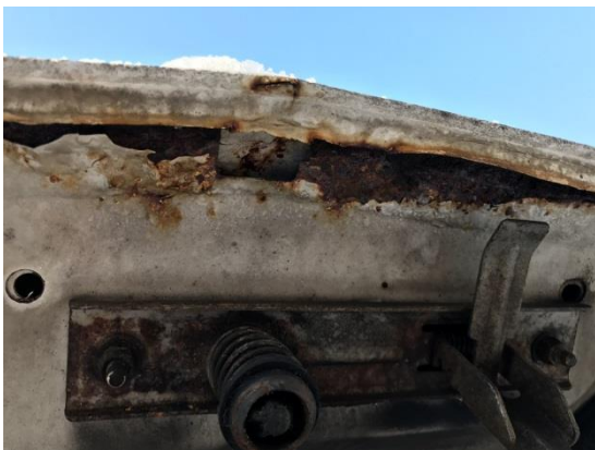
Rozsáhlá koroze částech karoserie
