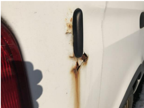
Rozsáhlá koroze částech karoserie
