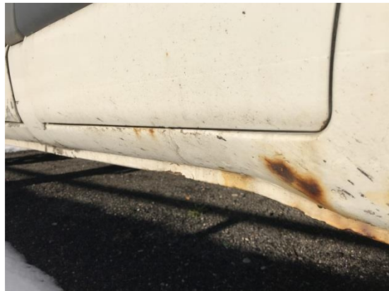
Rozsáhlá koroze částech karoserie
