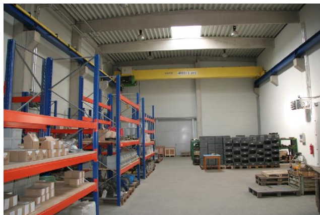
Sklad s automatickými vraty a jeřábovou dráhou 12,5 tun
