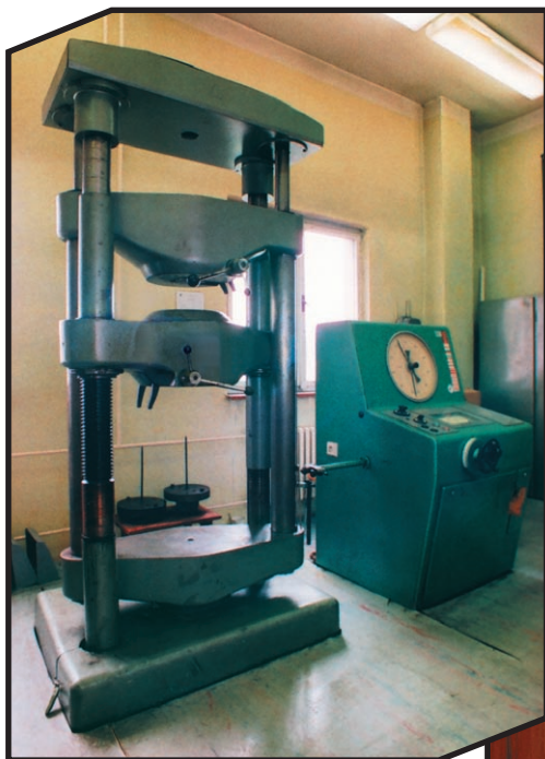
Trhací stroj ZD 100: 1000 kN Tensile test machine ZD 100: 1000 kN
