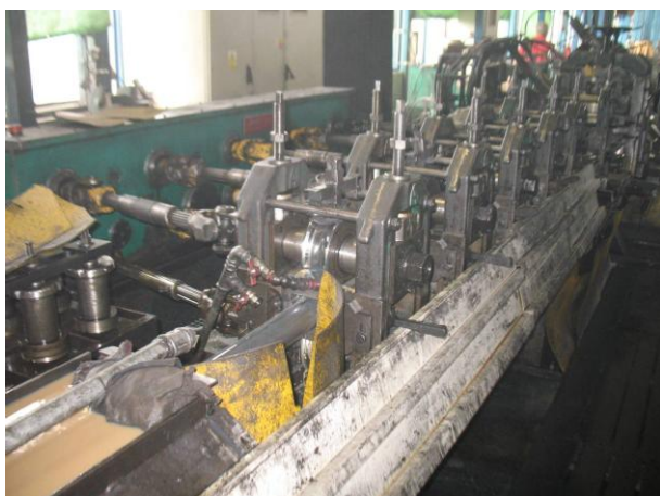
Foto 9 Válcovací linka SP 3 - tvarovací část
