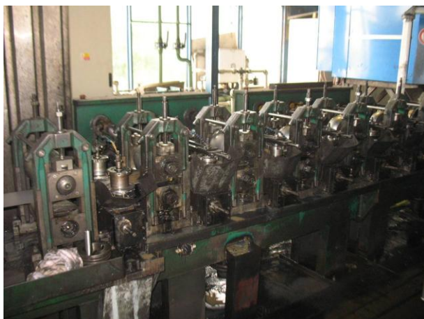
Foto 7 Válcovací linka SP 3 - profilovací část
