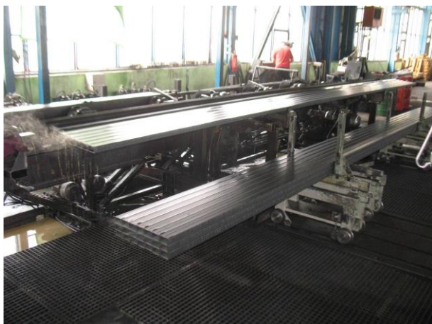
Foto 13 Válcovací linka SP 3 - výběhový stůl
