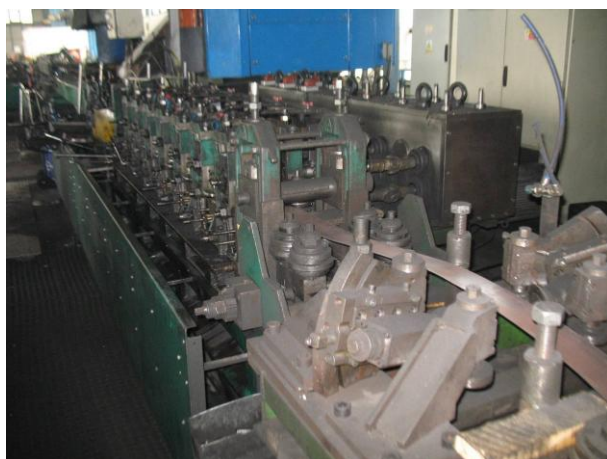
Foto 16 Válcovací linka SP 2 - profilovací část
