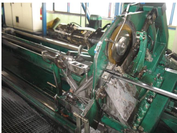
Foto 21 Válcovací linka SP 2 - letmé dělení
