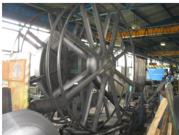
Foto 6 Válcovací linka SP 3 - dvoububnový akumulátor
