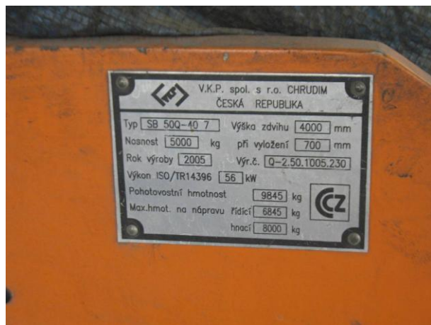
Foto 38 Výrobní štítek VZV boční SB 50Q-407
