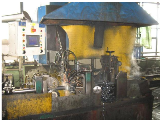
Foto 8 Válcovací linka SP 3 - svařovací agregát
