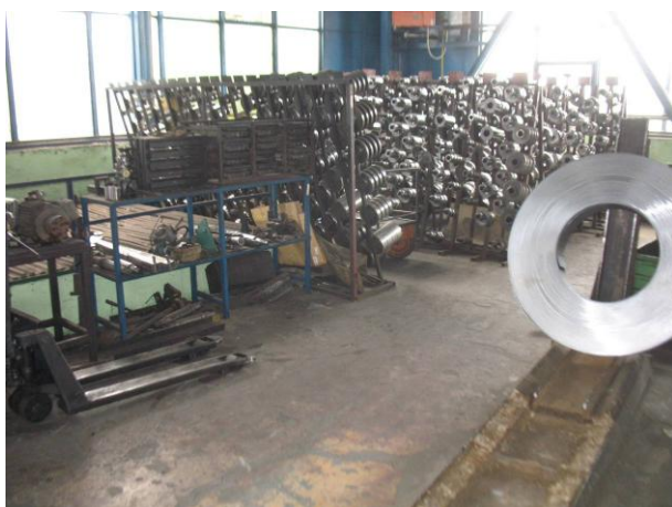
Foto 5 Válcovací linka SP 3 - nářadí, formovací válce
