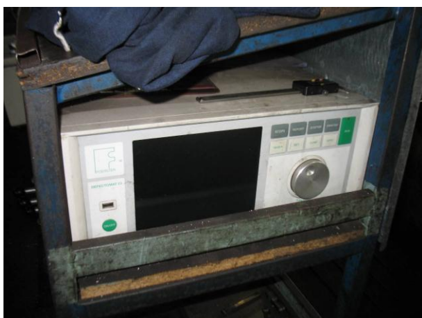
Foto 11 Válcovací linka SP 3 - elektronika defektometru CI 2.812
