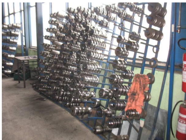
Foto 14 Válcovací linka SP 2 - nářadí, formovací válce
