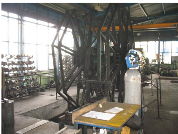
Foto 15 Válcovací linka SP 2 - dvoububnový akumulátor
