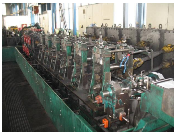
Foto 18 Válcovací linka SP 2 - kalibrační stolice
