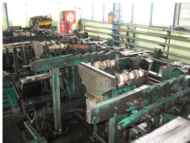
Foto 22 Válcovací linka SP 2 - výběhový stůl
