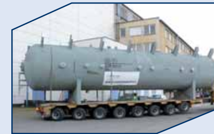
DELTAK, L.L.C. / General Electric Int., USA VT parní buben (O.D. 2920 mm, 115 t, 347 °C, 14,94 MPa) AS Pontes de Garcia Rodriguez Španělsko
