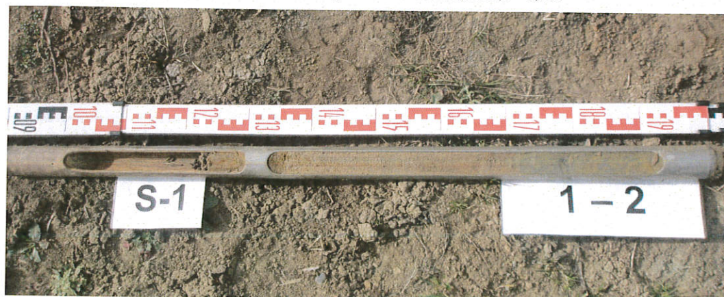
Obr. 3 Zastížené horniny sondou S-1 v hloubce 1,0 – 2,0 m
