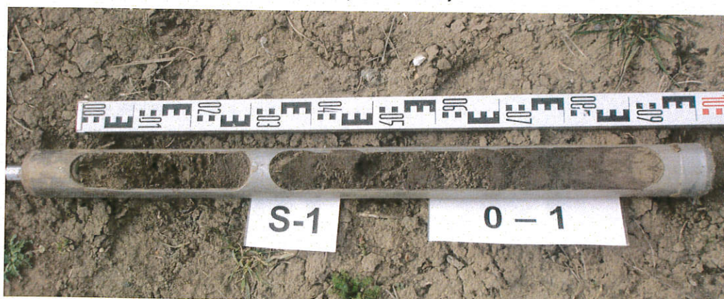
Obr. 2 Zastížené horniny sondou S-1 v hloubce 0,0 – 1,0 m
