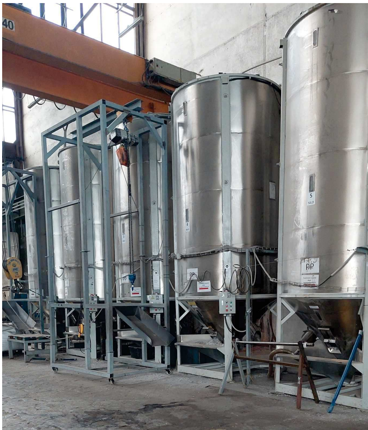
Homogenizační sila (5x 16 m 3 )
