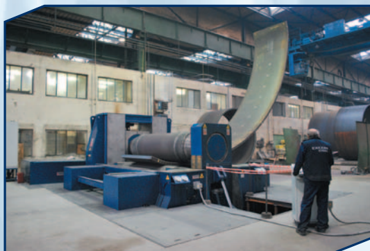
Faccin – zakružování plechů za studena / tepla, max. tloušťka 170 mm x šíře 3000 mm
