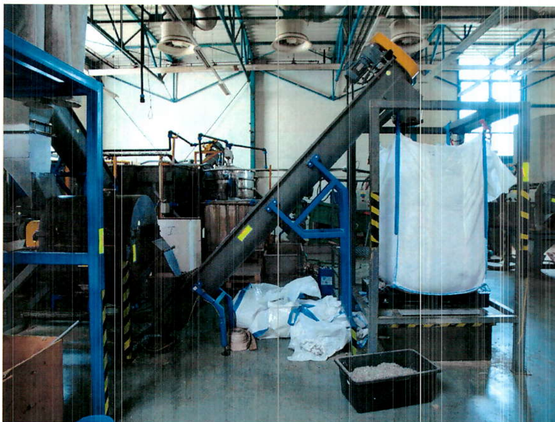
Obr. 27. Pol. 27: žlabový šnekový dopravník
