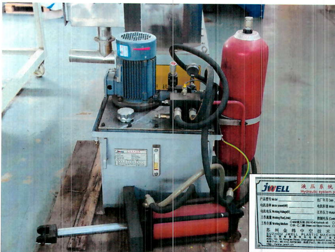
Obr. 55. Pol. 55. hydraulická jednotka k filtrační jednotce regranulace
