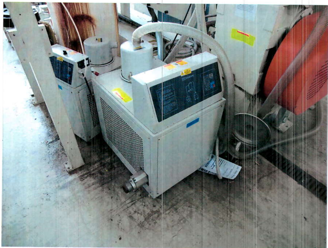
Obr. 51. Pol. 51: pneumatický automatický zásobní systém
