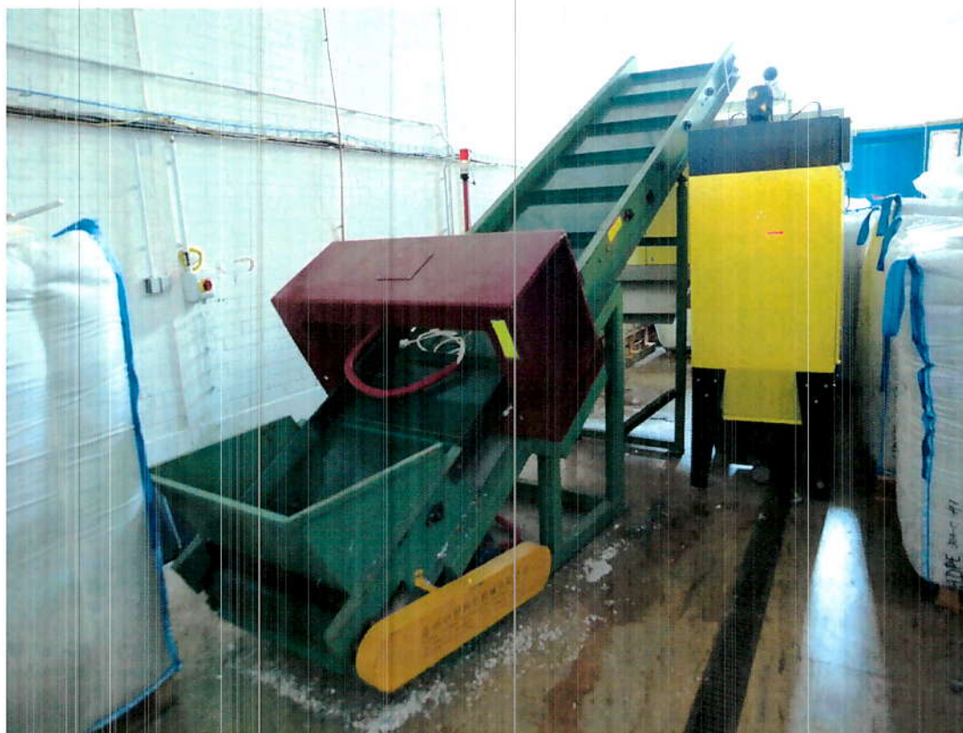
Obr. 45. Pol. 45: hradlový šikmý dopravník s detektorem kovů
