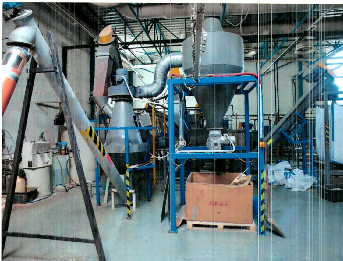
Obr. 26. Pol. 26: podtlakový separátor prachu
